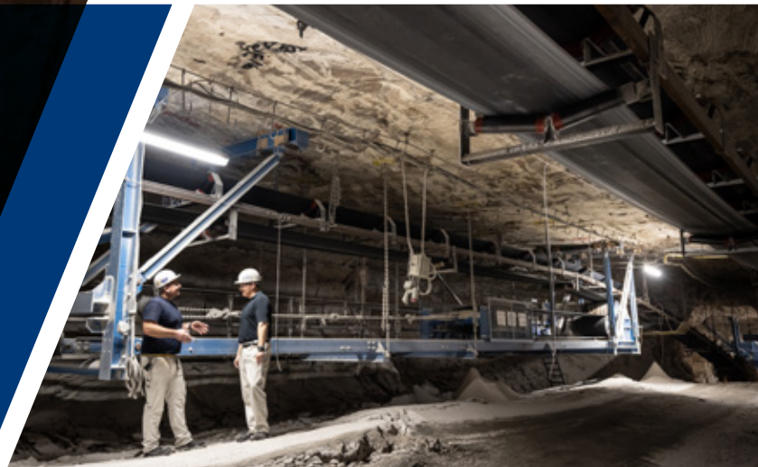
Der Sekundärabbau benötigt ein zusätzliches Transportband in der Grube, das das Versatzmaterial in das Abbaurevier befördert.
