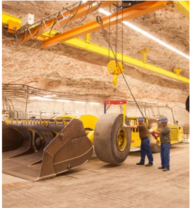
Die Reparatur und Wartung der unter Tage eingesetzten Fahrzeuge (im Bild ein Lader) erfolgt in den untertägigen Werkstätten.
