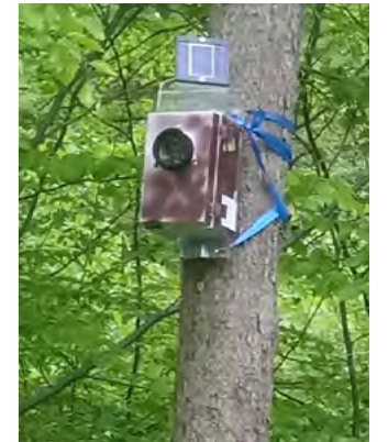
Ein Ultraschalldetektor zeichnet die Rufe auf und hilft die unterschiedlichen Arten zu erfassen
