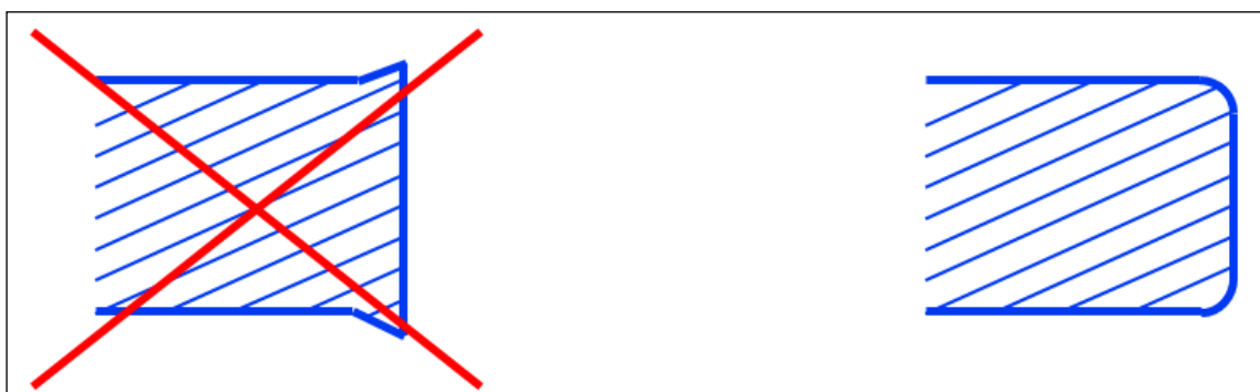
Abbildung 3 - Blechkantenausbildung mit Abrundung
